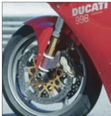
Die USD-Gabel von Showa reagiert sensibel auf Einstellungsveränderungen, die «normale» Brembo-Bremse genügt vollauf
